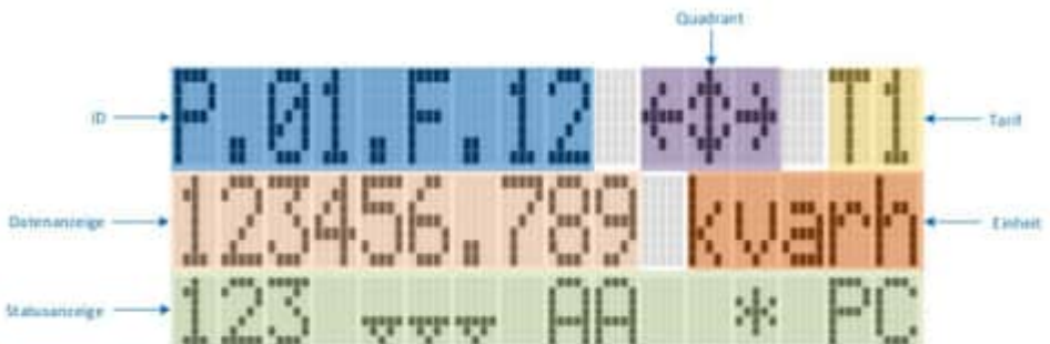
Abbildung 24 – Bildschirmaufbau des Displays
