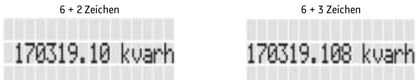
Abbildung 28 – Bildschirmbeispiel für Blindenergie-Register
