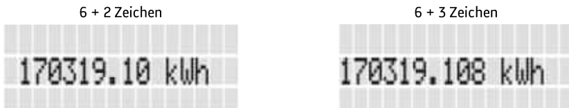
Abbildung 26 – Bildschirmbeispiele für das Wirkenergie-Register
