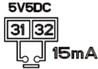
Abbildung 17 – Anschlussplan für externen Taster
